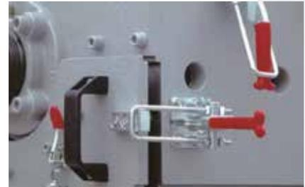
Das ZERMA-Quick-Snap System ermöglicht ein schnelles Abnehmen der geteilten Frontplatte zur einfachen Mühlenreinigung ohne den Einsatz von Werkzeugen. Die untere Frontplatte wird über 2 stabile Schnellspannverschlüsse gehalten.
