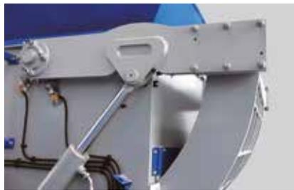
Die massiv ausgeführte Anpressvorrichtung mit ihrer überdimensionierten Lagerung sichert eine optimale Zuführung des Materials zum Rotor.
