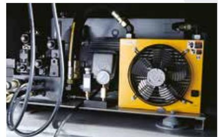
Hydraulik für Anpressvorrichtung und Siebkorb.
