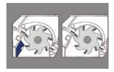
Am auswechselbaren Ableitkeil mit drittem Statormesser erfolgt der erste Schnitt des Rotors und beeinflusst somit in hohem Maße dessen Annahmeverhalten.
