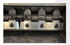
Die Mühle ist mit einem Rotor aus der GST-Baureihe ausgestattet, der auch für dickere und schwerere Materialien geeignet ist.
