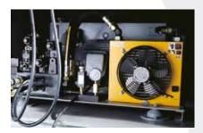
Hydraulik für Anpressvorrichtung und Siebkorb.
