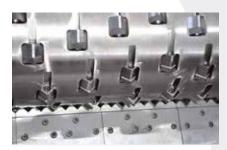
Die Shredder der ZIS-Baureihe verfügen über sehr große Rotordurchmesser mit glatter Oberfläche. Die Messer werden in Rotortaschen geschraubten Messerträgern gehalten. Für besonders abrassive Materialien steht optional eine spezielle Rotoroberflächenhärtung zur Verfügung.
