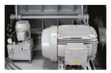
Um die Maschinenabmessungen möglichst kompakt zu halten, wurde der Schaltschrank, Motor und die hydraulische Öffnungsvorrichtung in die Lärmschutzbox integriert.
