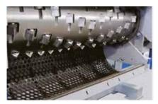
Geschraubte Siebeinlage hydraulisch auf und zu klappbar. Dadurch schnelle Zugänglichkeit.
