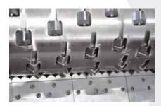
Alle ZERMA-Einwellenshredder sind mit großdimensionierten Rotordurchmessern und geschlossener Oberfläche ausgestattet. Die Messerfixierung erfolgt in geschraubten Messerhaltern, die komplette Einheit ist in einer Rotortasche fixiert.
