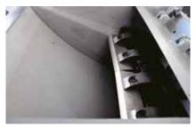
Die tangentiale Schneidkammer gepaart mit dem offenen Rotor-Design sorgt für eine zuverlässige Aufnahme von voluminösen Teilen. Die geschwungene Mahlkammer verringert das Materialstaurisiko.
