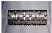
Die Rotoren sind mit konkav geformten Schneidkronen bestückt, die vierfach wendbar sind.
