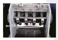
Das Maschinengehäuse sitzt in einer schallgedämmten Box, um einen leisen Betrieb zu gewährleisten. Der Mahlraum und das Sieb sind für die Reinigung und Wartung leicht zugänglich.
