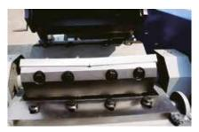
Je nach Aufgabenstellung stehen für die GSH-Baureihe verschiedene Rotoren zur Verfügung. Alle Rotoren arbeiten nach V-Schnittgeometrie, die stets ein qualitativ hochwertiges Mahlgut liefert.
