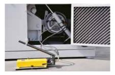
Zur Vereinfachung von Wartungs-/ Reinigungsarbeiten, Messer- und Siebwechsel wurde die GSC 500-Baureihe mit einer hydraulischen Öffnungsvorrichtung ausgestattet.
