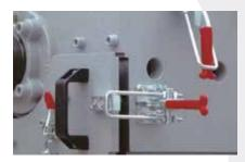
Das ZERMA-Quick-Snap System ermöglicht ein schnelles Abnehmen der geteilten Frontplatte zur einfachen Mühlenreinigung ohne den Einsatz von Werkzeugen. Die untere Frontplatte wird über 2 stabile Schnellspannverschlüsse gehalten.
