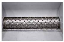
Die Rotoren sind mit konkav geformten Schneidkronen bestückt, die vierfach wendbar sind.
