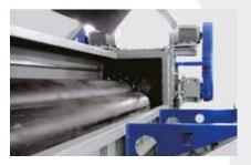
Die Maschine ist mit einem großzügig dimensionierten Beschicktrog ausgestattet, der die Zerkleinerung von Rohren mit einer Länge von bis zu 6 m ermöglicht. Ein leistungsfähiger, hydraulisch gesteuerter Schieber führt das Material zum Rotor.
