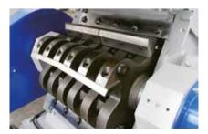
Dank des leicht geneigten Beschicktrichers können Langteile bequem zugeführt werden. Die Gefahr einer Rotorblockade oder einer Mahlraumüberfüllung ist ausgeschlossen, da die Maschine selbsttätig dosiert.
