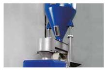
Das Material wird über eine Dosierrinne aufgegeben, die sowohl über die Stromaufnahme des Antriebsmotors als auch über das Temperaturkontrollsystem gesteuert wird.
