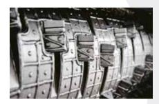
Die Rotoren der ZTS-/ZTTS-Baureihe verfügen mit 760 mm über einen sehr groß dimensionierten Durchmesser. Ihre Oberflächen sind mit einer aufgeschweißten Hardox-Schutzpanzerung versehen. Die Messer werden in Rotortaschen geschraubten Messerträgern gehalten.
