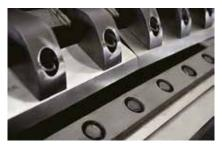
Je nach Aufgabenstellung stehen für die GSH-Baureihe verschiedene Rotoren zur Verfügung. Alle Rotoren arbeiten nach V-Schnittgeometrie, die stets ein qualitativ hochwertiges Mahlgut liefert.
