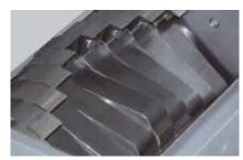
Durch die versetzt angeordneten Rotorsterne sind immer nur einzelne Messer im Einsatz, wodurch eine jeweils höhere Schnittkraft erreicht wird. Sämtliche Maschinen aus der GSL-Baureihe eignen sich somit auch für massivere und dickere Angüsse.
