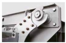
Das überdimensionierte Getriebe wird über eine äußerst robuste Drehmomentstütze gehalten, die es gegen starke Schläge während des Mahlvorganges schützt.
