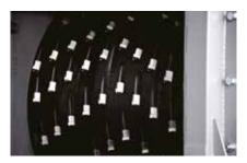
Die Shredder der ZRS-Baureihe verfügen über sehr große Rotordurchmesser mit glatter Oberfläche. Die Messer werden in Rotortaschen geschraubten Messerträgern gehalten.
