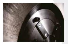
ZERMA-Prallscheibenmühlen können entweder mit einteiligen Scheiben oder mit Mahlsegmenten bestückt werden. Scheiben wie auch Segmente sind aus hochwertigem Werkzeugstahl gefertigt und können zusätzlich mit einer verschleißarmen Beschichtung behandelt werden.
