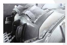
Die Messer sind auf verschweißten Messerträgern verschraubt. Der massiv ausgeführte Rotor mit seiner glatten Oberfläche und aufgeschweißten Werkzeugen sorgt für eine effiziente und schonende Zerkleinerung für eine Vielzahl von Materialien.
