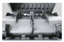
Das Zusammenwirken der Rotor- und Statorwerkzeuge setzt enorme Aufprallkräfte frei, die letztendlich in sehr hohen Durchsatzleistungen resultieren.
