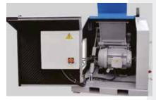
Um die Maschinenabmessungen möglichst kompakt zu halten, wurde der Schaltschrank in die Lärmschutzbox integriert.
