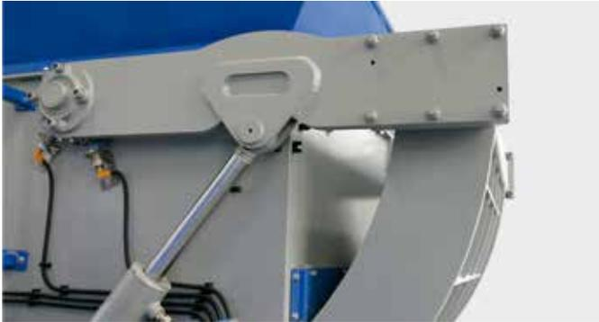
Die Shredder der ZSS / ZPS und ZXS-Baureihe sind mit einer sehr stabilen und berührungslosen Anpressvorrichtung ausgestattet, d.h. sie benötigt keine zusätzlichen Führungen, die verschleifen könnten. Zwei leistungsstarke Hydraulikzylinder und der massive Zuführschieber garantieren eine zuverlässige und kraftvolle Zuführung des Materials zum Rotor.
