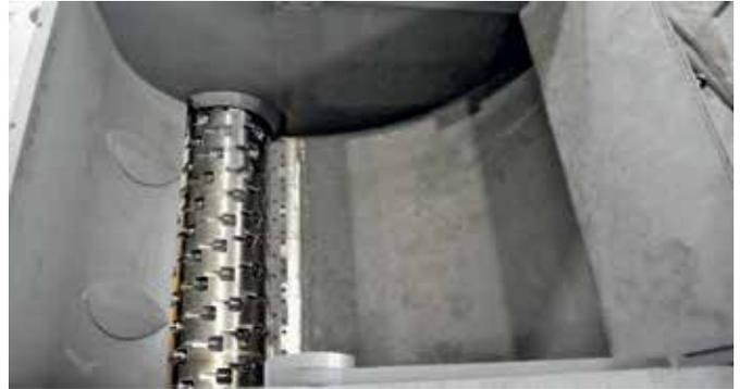
Die Maschinen der ZIS-Baureihe verfügen über ein besonders großes Trichter- und Mahlkammervolumen und benötigen doch nur einen relativ geringen Platzbedarf. Diese Shredder sind hauptsächlich für die Zerkleinerung von großvolumigen Hohlkörpern ausgelegt.
