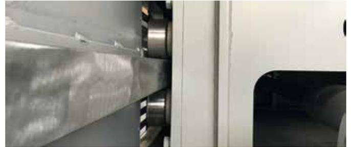
Die Schieber der ZHS und ZRS Baureihe laufen auf überdimensionierten und hoch belastbaren Stahlrollen. Dies verhindert ein Verkanten des Schiebers sowie einen geringeren Verschleiß.
