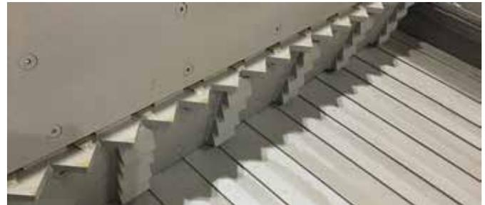
Alle Einwellenzerkleinerer sind an der Vorderseite des Materialschiebers mit einer Zackenleiste ausgestattet. Diese garantiert einen sicheren Halt des Aufgabegutes und zuverlässige Zuführung in den Rotor.
