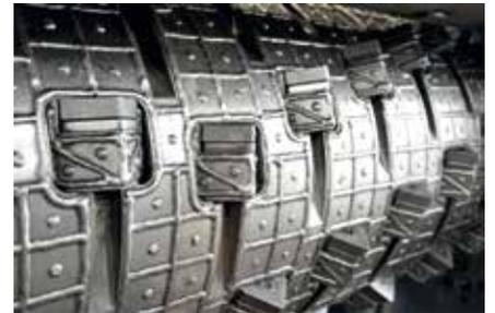
Für besonders abrasive und verschleißende Materialien können die Rotoren und Messerhalter mit einer verschleißschützenden Schweißoberfläche versehen werden. Zusätzlich stehen Messer aus Wolfram-Carbid für eine längere Lebensdauer zur Verfügung, die beispielsweise bei der Zerkleinerung von Reifen eingesetzt werden.
