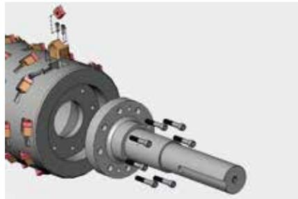
Rotorwellenende und Messerhalter werden in den Rotor eingeschraubt, was Reparaturarbeiten enorm vereinfacht. Außerdem stellen sie eine sog. Sollbruchstelle dar, um die Maschine vor schlimmeren Schäden zu schützen.
