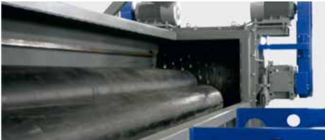
Die ZRS-Shredder sind mit einem speziellen Zuführtrog ausgestattet, der es ermöglicht, Rohre von bis zu 6 m Länge zu zerkleinern. Ein äußerst leistungsfähiges Hydrauliksystem sorgt für eine sichere Zuführung der Rohre zum Rotor.
