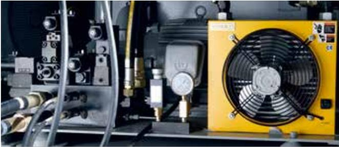
Alle Shredder verfügen über eine leistungsstarke Zweistufenhydraulik. Diese garantiert einen gleichbleibend hohen Druck bei der Zuführung des Materials zum Rotor und ermöglicht außerdem eine erhöhte Geschwindigkeit des Hydraulikschiebers in der Rückwärtsbewegung.
