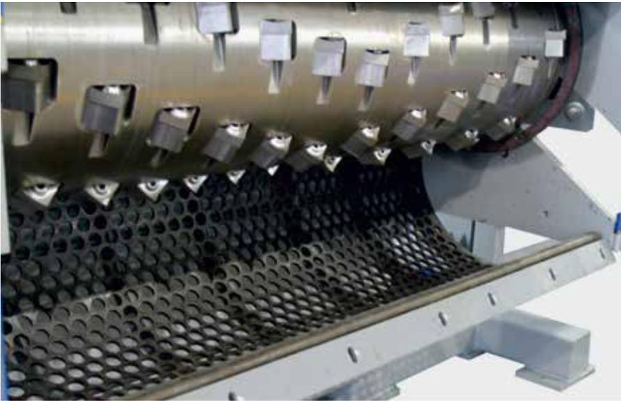
Die Shredder verfügen über einen sogenannten E-Rotor mit glatter Oberfläche, in die die Taschen für die verschraubbaren Messerhalter eingearbeitet sind. Der Siebkorb ist hydraulisch abschwenkbar, was den Messer- und Siebwechsel bedienerfreundlich gestaltet.
